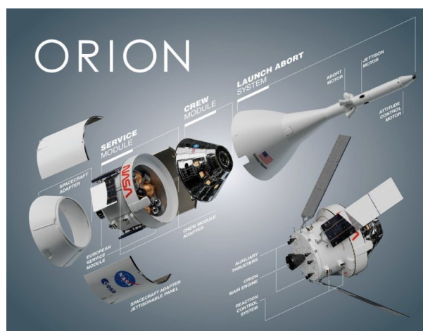
Aufbau der Orion-Raumkapsel in der Startkonfiguration (oben) und beim Flug um den Mond.
